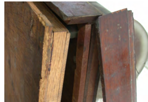
Classes de fusta: interior de roure i exterior de caoba
