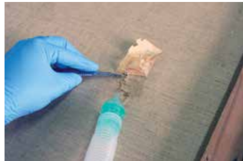
Eliminació del pedaç (amb ajuda de l'humificador ultrasònic)
