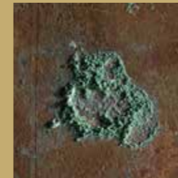
Corrosió del suport en forma de clorurs (principalment al revers)
